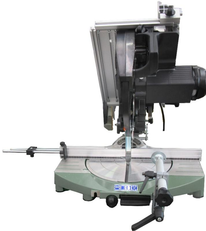
Máquina de corte de cabeça única portátil com plano superior com guia para a aparagem da peça. Dotada de cárter de proteção da lâmina e grupo de serra inclinável no eixo horizontal até 45° no lado esquerdo, no eixo vertical de - 45° a + 45°. Predisposição em ambos os lados para a aplicação de morsa de bloqueio da peça, horizontal. Permite o corte em qualquer ângulo intermediário.
