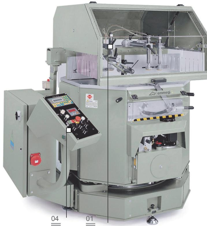
Unterflur-Schifterschnittsäge mit automatischem CNC-gesteuertem Schwenken um die vertikale Achse über Gleichstrommotor und gleichzeitigem hydraulischem Schwenken um die horizontale Achse. Gehrung vertikal von 90° bis 22°30' (links und rechts) und horizontal von 90° bis 35° (nur rechts). Ausgestattet mit digitaler Gehrungsanzeige (horizontal).
