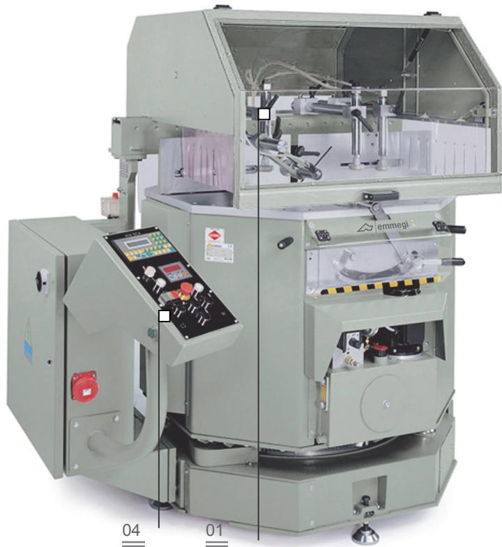
Tronzadora monocabezal ascendente, rotación automática - con control numérico - del eje vertical por medio de un motor en C.C e inversión simultánea del eje horizontal accionado hidráulicamente. Permite efectuar cortes en angulaciones de 90° a 22°30' (a la izquierda y a la derecha) en el eje vertical y de 90° a 35° (sólo a la derecha) en el eje horizontal. Se suministra con visualizador digital de cota para el eje horizontal.
