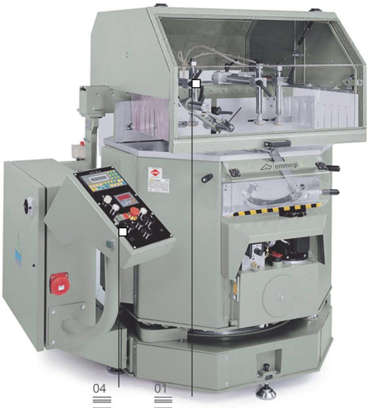
Troncatrice monotesta ascendente con rotazione automatica a controllo numerico dell'asse verticale mediante motore a C.C. e contemporaneo ribaltamento a comando idraulico dell'asse orizzontale. Tagli con angolazioni da 90° a 22°30' (sinistra e destra) sull'asse verticale e da 90° a 35° (solo a destra) sull'asse orizzontale. Equipaggiata con display di quota digitale per asse orizzontale.
