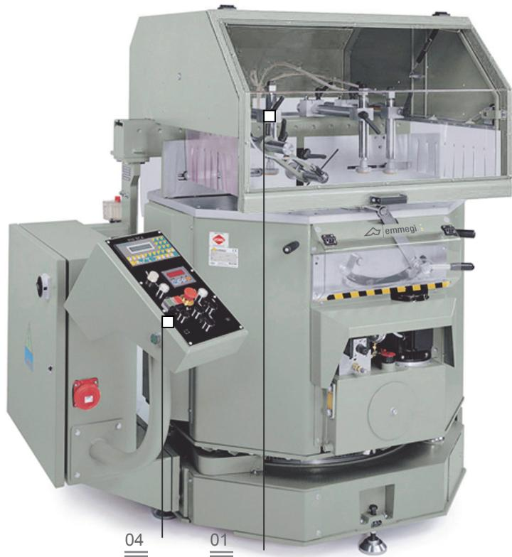
Máquina de corte monocabeça ascendente com rotação automática, por controle numérico, do eixo vertical mediante motor de C.C. e simultâneo basculamento, por comando hidráulico, do eixo horizontal. Cortes com ângulos de 90° a 22°30' (à esquerda e à direita) sobre o eixo vertical e de 90° a 35° (somente à direita) sobre o eixo horizontal. Equipada com display de cota digital para eixo horizontal.
