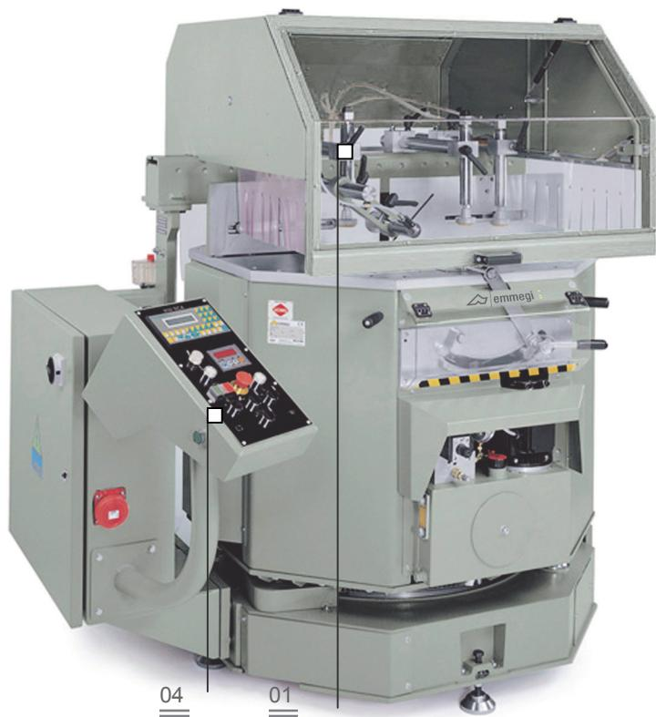
上行式的单头切割机，垂直轴通过数控可自动地旋转（由直流电动机驱动），同时通过液压系统，水平轴可倾斜。在垂直轴上，切割范围为左/右 90° 到 22°30'；在水平轴上，切割范围为右边 90° 到 35°。配有水平轴尺寸的数字显示器。
