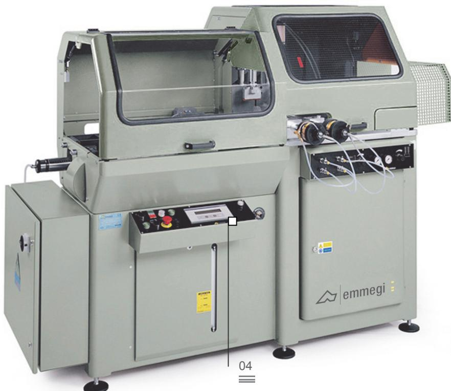
Kreissägewollautomat mit von unten kommenden Sägeblatt für 90° Schnitte, ausgerüstet mit Materialvorschub mit Festanschlag, Längeneinstellung und Positioniergenauigkeit  $\pm 0,1$  mm. Die Maschine ist ebenfalls mit einem hydropneumatischen Sägeblattvorschub ausgestattet.
