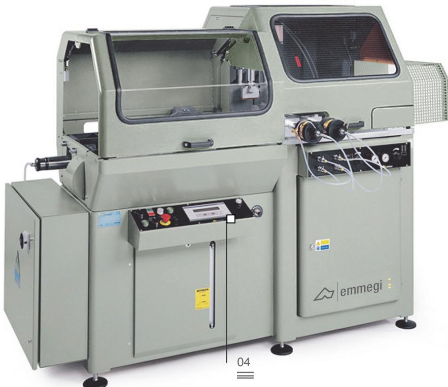
Máquina de corte monocabeça ascendente, com ciclo automático, para o corte a 90°, equipada com sistema de avançamento da barra de encosto mecânico, com regulação do comprimento e da tolerância de corte até de ± 0,1 mm. Além disso, a máquina é caracterizada por um sistema de avançamento pneumático da lâmina de corte.
