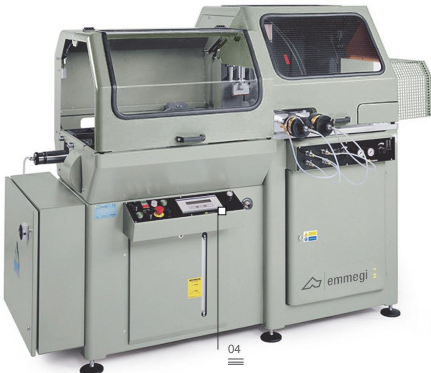
Sågautomat med underifrån kommande klinga för kapning vid endast 90°, utrustad med frammatringssystem för stång med mekaniskt stopp, med justering av längden och av toleransen för kapningen upp till  $\pm 0,1$  mm. Maskinen är dessutom försedd med ett pneumatiskt klingmatning.
