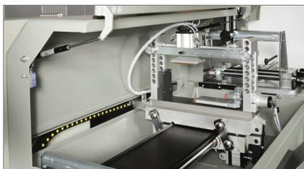
Прижимы мостового типа подающего устройства (опция) 01
