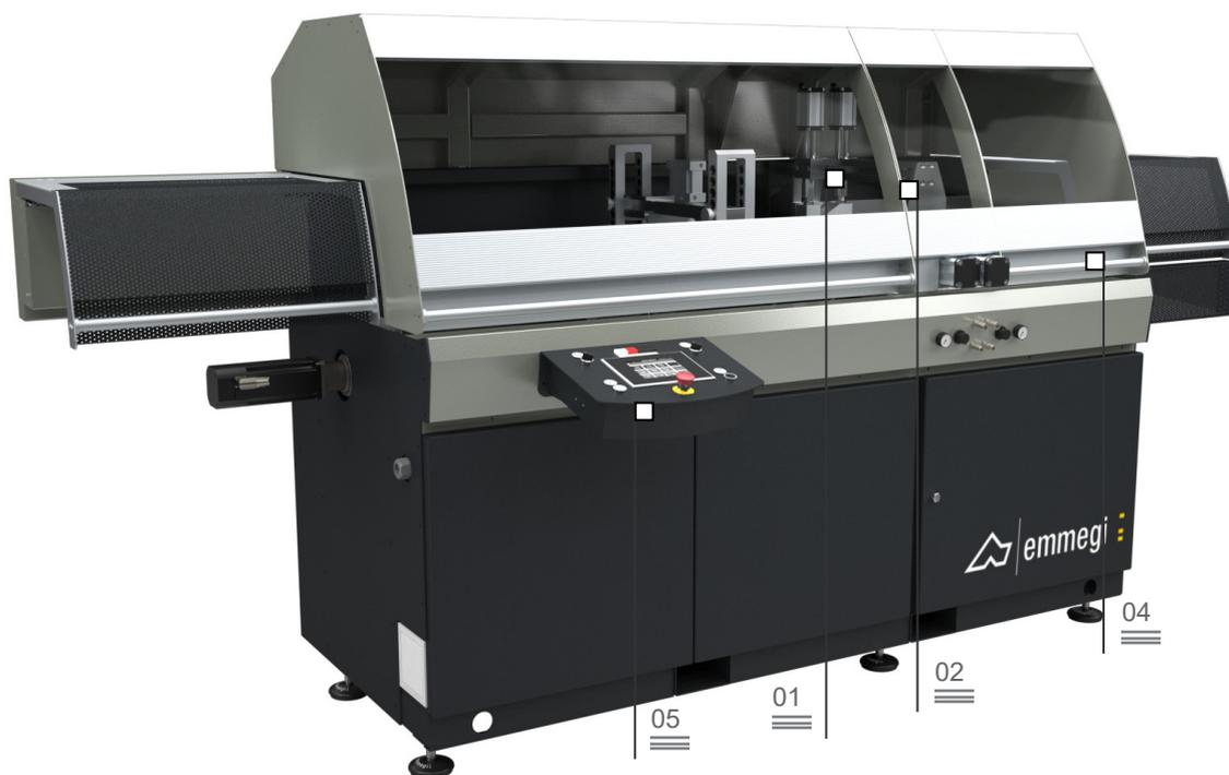
Автоматическая одноголовочная пила с нижней подачей диска для резки под углом 90°, оснащена электрической системой подачи профилей, управляемой ЧПУ. Возможна оснастка дисками четырех различных диаметров, электрическая подача диска под управлением ЧПУ.
