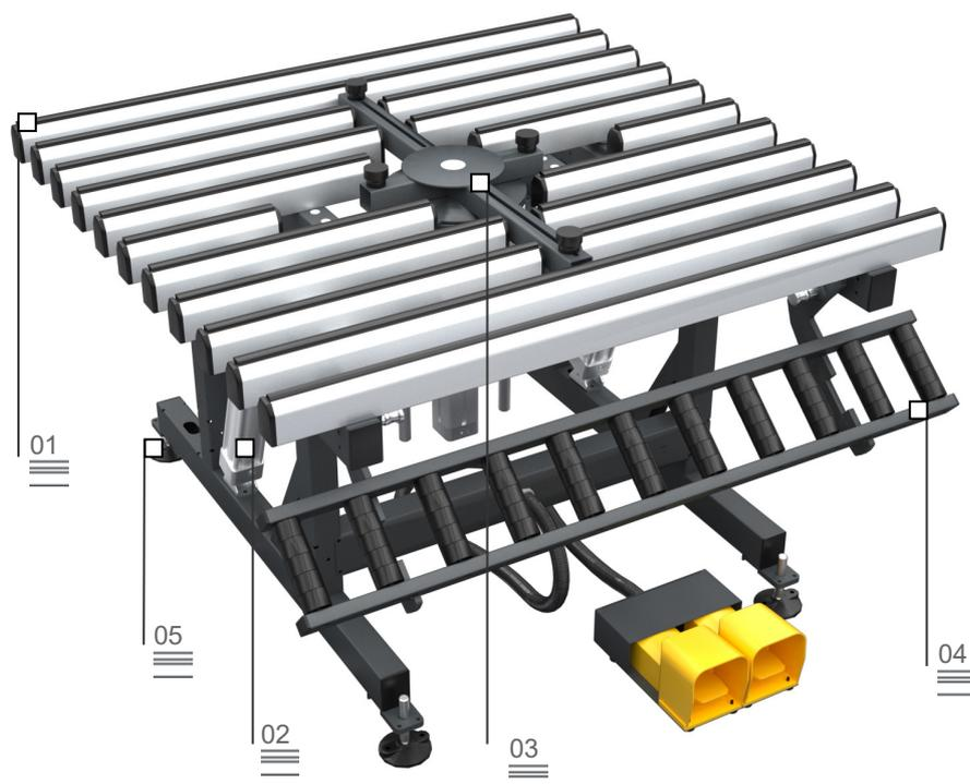
Banco per l'assemblaggio di ante con vetro, con piano di lavoro inclinabile da 0° (orizzontale) a 85°. La rulliera a scomparsa è regolabile in altezza (da 170 a 460 mm) indipendentemente dal piano di lavoro. Il piano di lavoro è regolabile da 895 a 965 mm e i piedini sono provvisti di fori per il fissaggio a terra. Viene corredato di una crociera centrale per il sollevamento ed il posizionamento del vetro.
