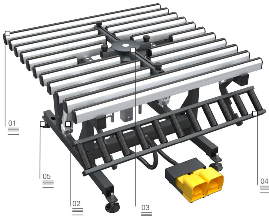
Стол для остекления створок, имеющий рабочую поверхность с возможностью наклона от 0° (горизонтальное положение) до 85°. Передающий ролик регулируется по высоте (в диапазоне от 170 до 460 мм), независимо от рабочей поверхности стола. Поверхность рабочего стола регулируется от 895 до 965 мм, стопы оборудованы отверстиями для крепления к полу. Стол оборудован центральной крестовиной для подъема и установки положения стекла.
