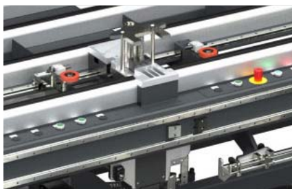
Module de perçage à trois forets 03
