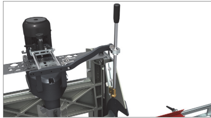
Umlenkhebel für das Verfahren des Kopfs 01
