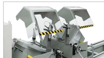
Pivotement des têtes mobiles 02
