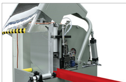
Dispositif de mesure électronique de l'épaisseur du profilé 04
