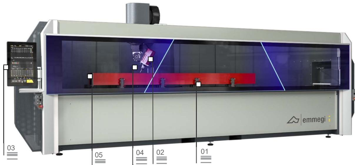
5-осевой автоматический обрабатывающий центр с ЧПУ, предназначенный для обработки профилей и заготовок из алюминия, ПВХ, различных легких сплавов и стали длиной до 4 м.
