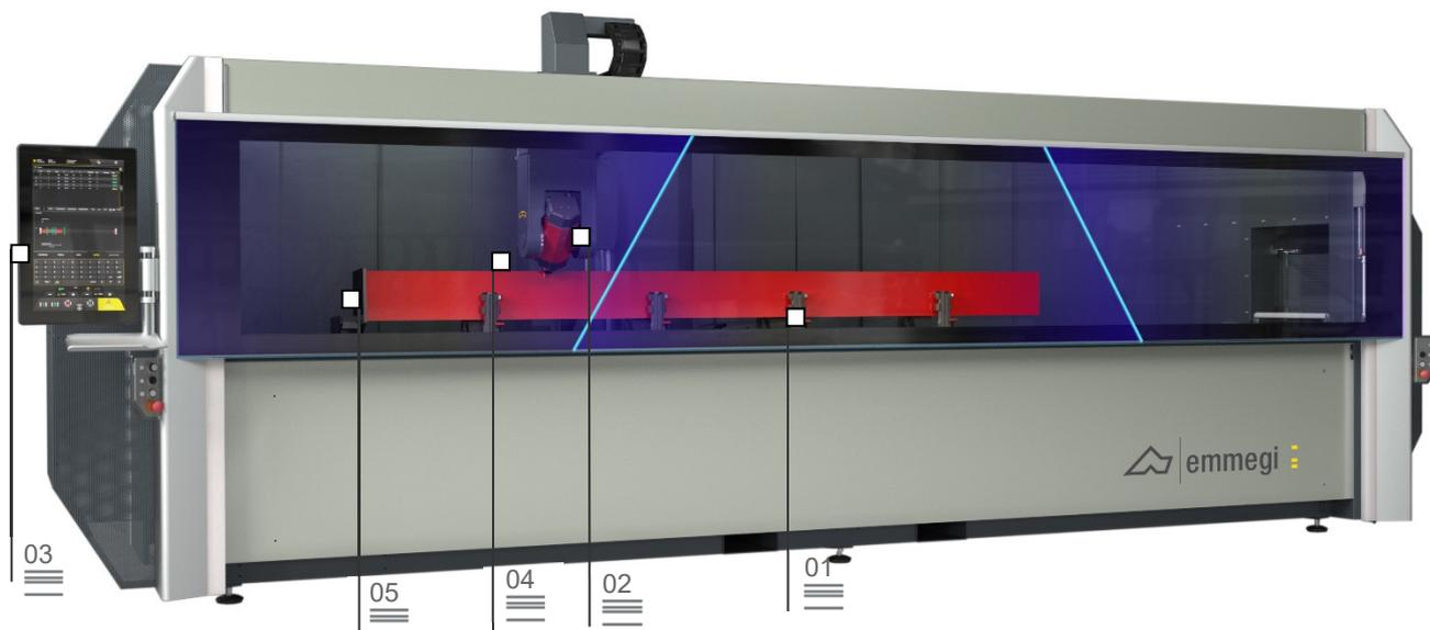
4-осевой автоматический обрабатывающий центр с ЧПУ, предназначенный для обработки профилей и заготовок из алюминия, ПВХ, различных легких сплавов и стали длиной до 4 м.
