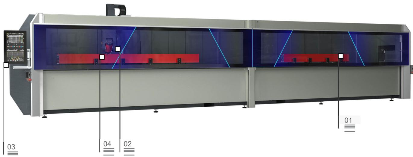
Centro di lavoro CNC a 4 assi controllati dedicato alla lavorazione di barre o pezzi in alluminio, PVC, leghe leggere in genere e acciaio. Prevede due diverse modalità di funzionamento: la prima, in modalità monozona, consente la lavorazione in un'unica area di lavoro di barre intere di lunghezza massima di 7 m; la seconda, in modalità pendolare, consente l'esecuzione di più pezzi nelle due aree di lavoro distinte.
