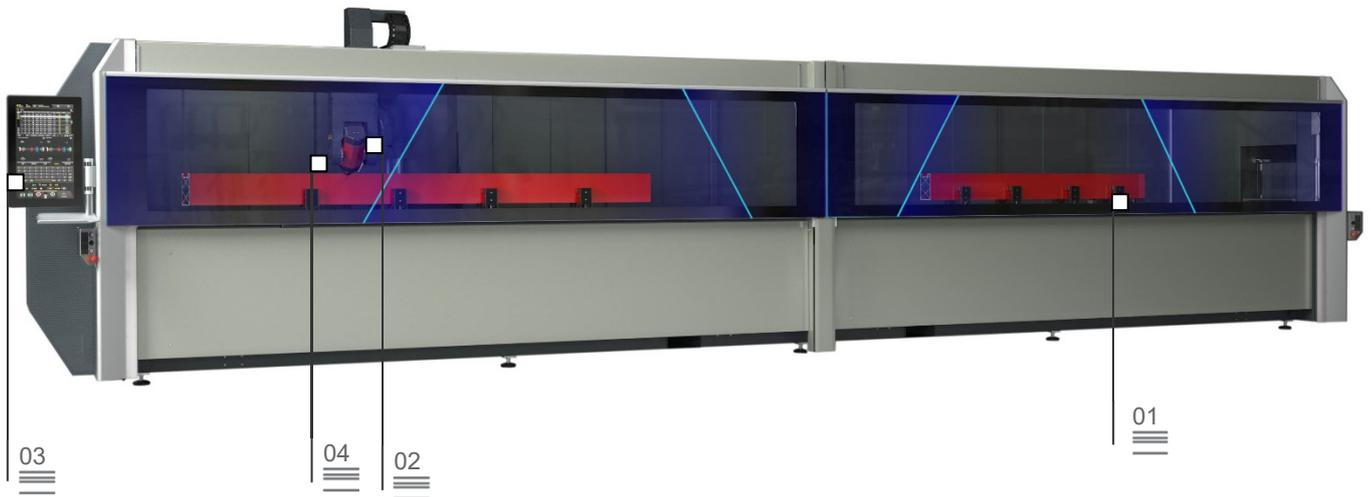
Centro de mecanizado CNC de 4 ejes controlados para la elaboración de barras o piezas de aluminio, PVC, aleaciones ligeras en general y acero. Posee dos modalidades de funcionamiento: un área única de trabajo para barras de hasta 7 m de longitud o dos áreas de trabajo en modalidad pendular independientes.
