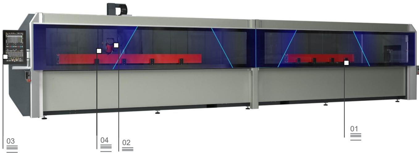
Centro di lavoro CNC a 4 assi controllati dedicato alla lavorazione di barre o pezzi in alluminio, PVC, leghe leggere in genere e acciaio. Ha due modalità di funzionamento: o un'area unica di lavoro per barre sino a 7 m di lunghezza o due aree di lavoro indipendenti in modalità pendolare.
