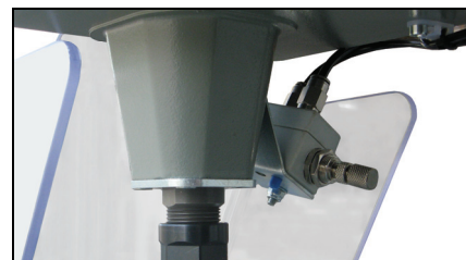
Système de lubrification
