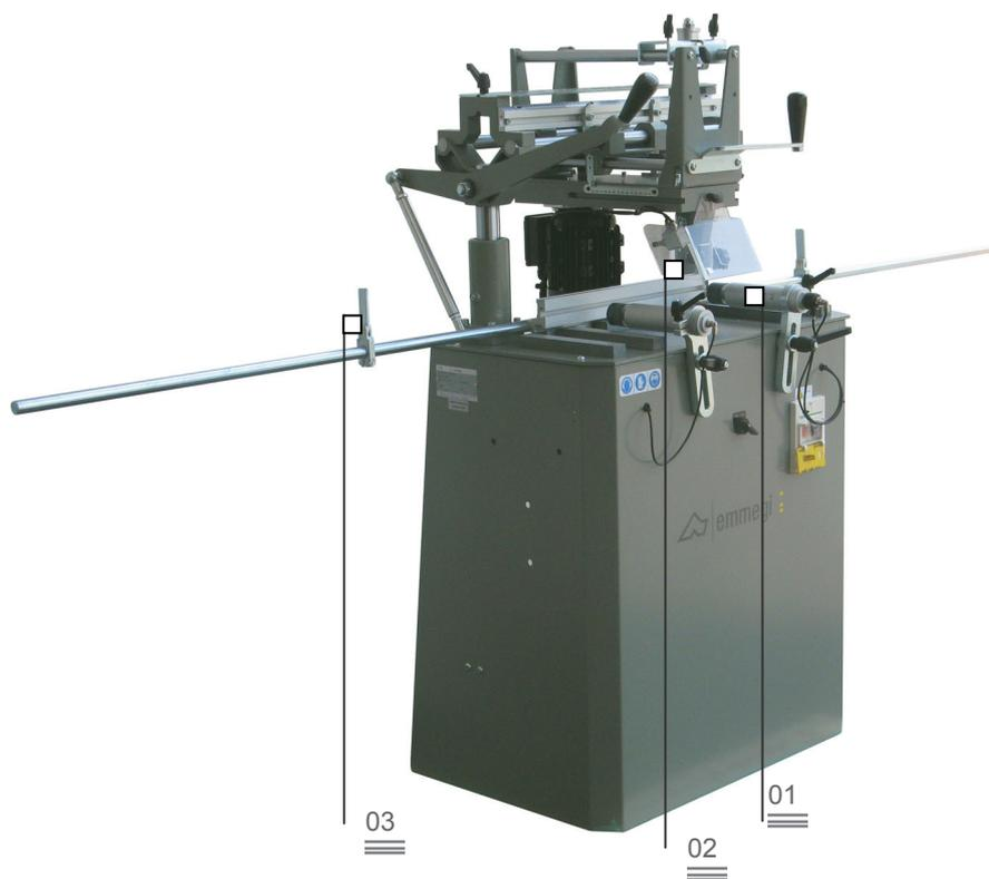
Copia 314 S - одношпиндельный копировально-фрезерный станок с ручной подачей фрезы, широким диапазоном вертикального хода и перемещением шпинделя с помощью направляющего рычага. Имеется возможность выполнять сквозные обработки без вращения заготовки. Копировальный штифт ручного управления.
