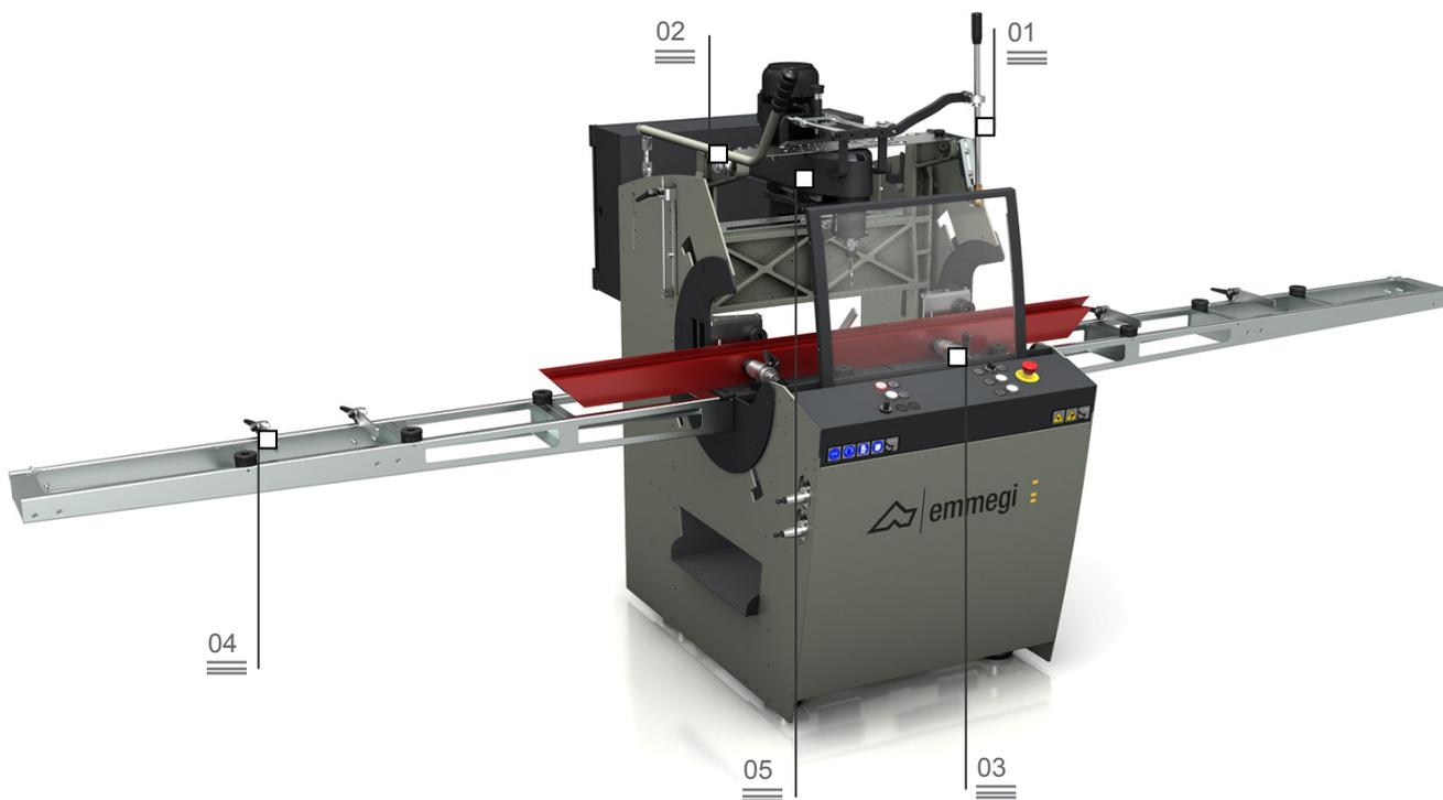
Pantografo monotesta a comando manuale con bloccaggio pneumatico e movimento di traslazione testa attraverso leva indiretta. Velocità di rotazione utensile modificabile con variatore elettronico per permettere le lavorazioni su acciaio fino a 2 mm, e per migliorare la qualità delle fresature e la durata dell'utensile. Possibilità di eseguire lavorazioni passanti su alluminio senza girare il pezzo. Piano di lavoro antigraffio. Tastatore pneumatico con comando su impugnatura.
