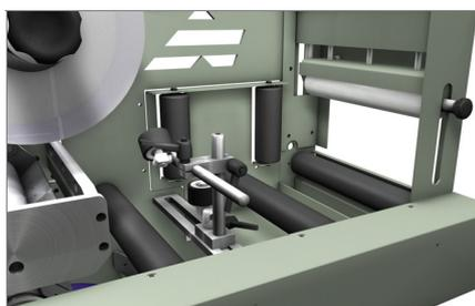
Подающий конвейер и разгрузочный магазин (опционально) 04
