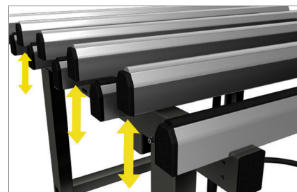
Pneumatisk växling av uppläggningsytan 04
