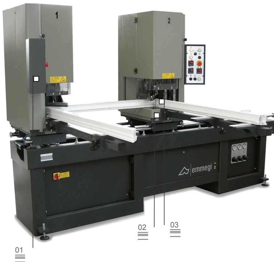
自动嵌入式焊接机，一端固定另一端可移动，适用于加工 90 度的角，FUSION 2LL 设计焊接长度最大可达 2440 mm。FUSION 2LL 的配置的加热焊缝，可调整范围从 0.2 到 2 mm；该机具有垂直的可沿直线导轨移动的挡块。通过支撑臂的高度调节，焊透深度可以设定在 2.5 或 3 mm。FUSION 2LL 可以加装各种垫块（选配）从而可以夹持加工所有的标准、亚克力和贴面型材。配有快速更换装置以便特氟隆薄膜的清洗。运工作循环由 PLC 控制，加热板由数字温控器控制；加热和焊接的时间可以在 LCD 显示屏上设置。
