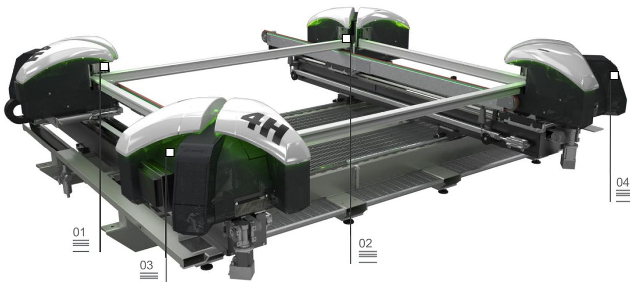
FUSION 4H est une soudeuse horizontale à commande numérique par ordinateur conçue pour le soudage de profilés en PVC. Conçue en deux dimensions, elle permet de fabriquer des cadres par soudage simultané des quatre angles à 90°.
