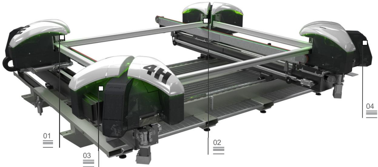
FUSION 4H é a soldadora horizontal com controlo numérico para a solda de perfis em PVC. Realizada em duas dimensões diferentes, permite produzir estruturas por meio da solda simultânea dos quatro ângulos em 90°.
