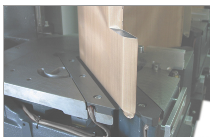
Réglage de la profondeur de fusion
