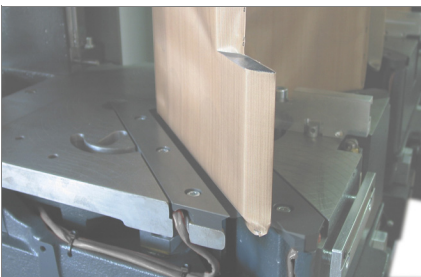
Kaynak yapılacak malzemenin yerleştirilmesi
