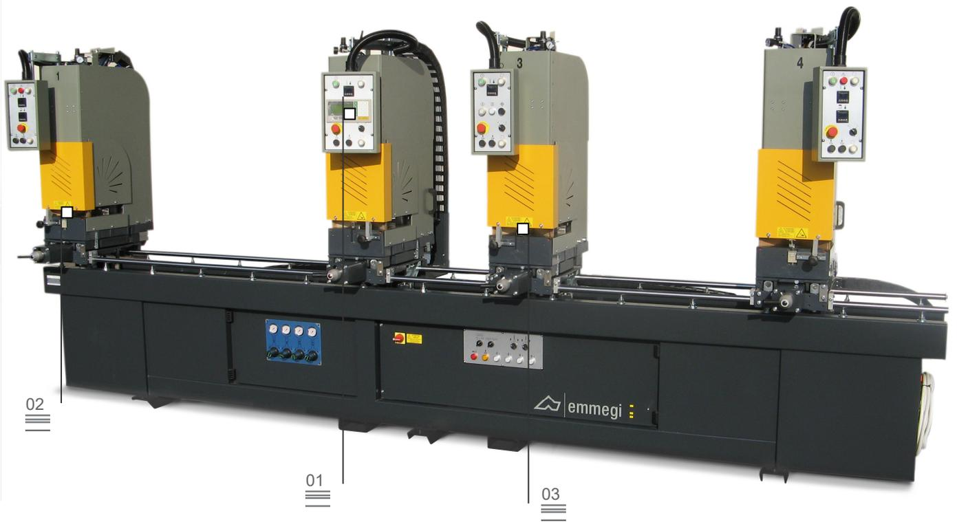
4 个头在线焊机，全自动周期，用于 90° 角度，从 30° 到 180° 可变角度，T 型横条，H 型横条和 + 十字横条。FUSION 4 TVH 有三个不同长度 (3.440, 4.440 和 5.440)，另外用 1 个或者多头能够同时给 3 个框架加热。配有的加热焊缝限制器可以调节在 0,5 到 2 mm 范围内。FUSION 4 TVH 有滑动垂直夹具。焊接深度可以调节在 2,5 或者 3 mm，另外可以调节支撑架的高度。根据需要，FUSION 4 TVH 可以配样板 (另外加的)，以加工所有的标准、亚克力和贴面型材以及大规格的型材(单件)。配有快速更换装置以便特氟隆薄膜的清洗。运转周期由 PLC 控制的，加热板由数字温度调节器控制 (可设置 °C 或 F)。通过 LCD 显示器，可以设定加热时间和焊接时间。
