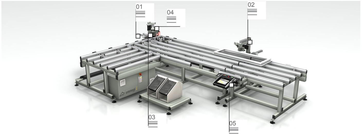
Bancada automática com visão artificial para o aparafusamento automatizado de ferramenta com passo constante ou variável em molduras para a serralheria com um amplo plano de trabalho que permite movimentar e girar estruturas de grandes dimensões.
