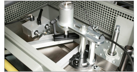
Spanneinrichtungen und nicht rechtwinklige Fräsbearbeitung 02
