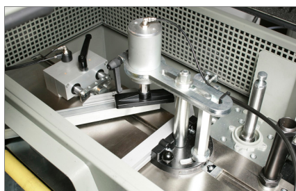
Klampenhet och ej rätvinklig fräsbearbetning 04
