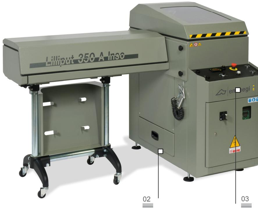
电磁气动进给的水平端铣床。配有防护外套，自动工作周期。可进行非直角+45° / 90° / -45°的切割。工具旋转速度由电子变速器控制来提高已经喷漆和非直角型材的加工质量。气动快速更换工具。防磨损的工作台面。工作区带全面保护和隔音装置。1100 mm 或 2000 mm 长、自动隔音隧道，能够把机器噪声减少到大约 75 dB (限于 90°直角的铣削)。在进给时消除了定位槽和工件之间的接触。
