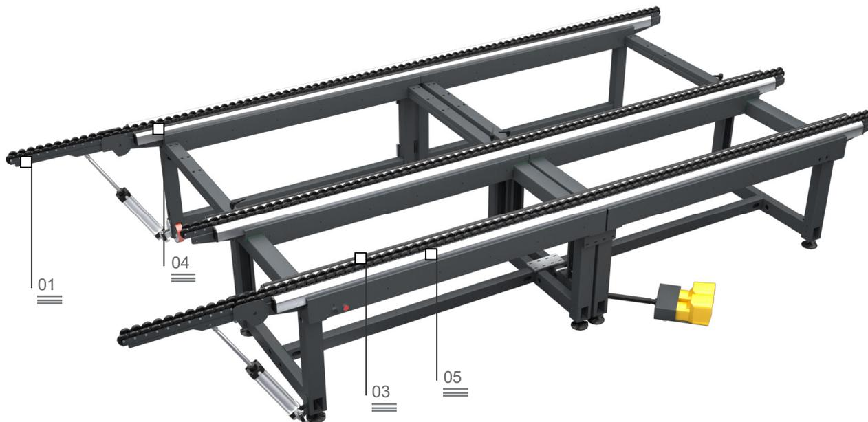
Großer, ausziehbarer Montagetisch mit modularem Aufbau für die Montage von Fenstern, Türen und Fassadenteilen. Der Montagetisch ist mit drei unterschiedlichen Arbeitsflächen ausgestattet: eine mit weichem PVC-Überzug für die Montagearbeiten, eine mit hartem PVC-Überzug für die Drehung und eine Rollenbahn für den Transport innerhalb der Fertigungslinie.
