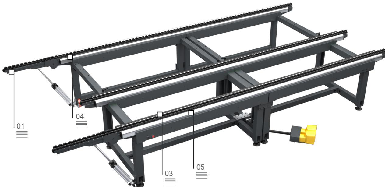
大规格的组件型装配台，适合于装配窗门和建筑用的玻璃板框架。配有三个不同材料的工作台：防滑软质 PVC 工作台用于装配，防摩硬质 PVC 工作台用于旋转，辊道用于窗门移动。
