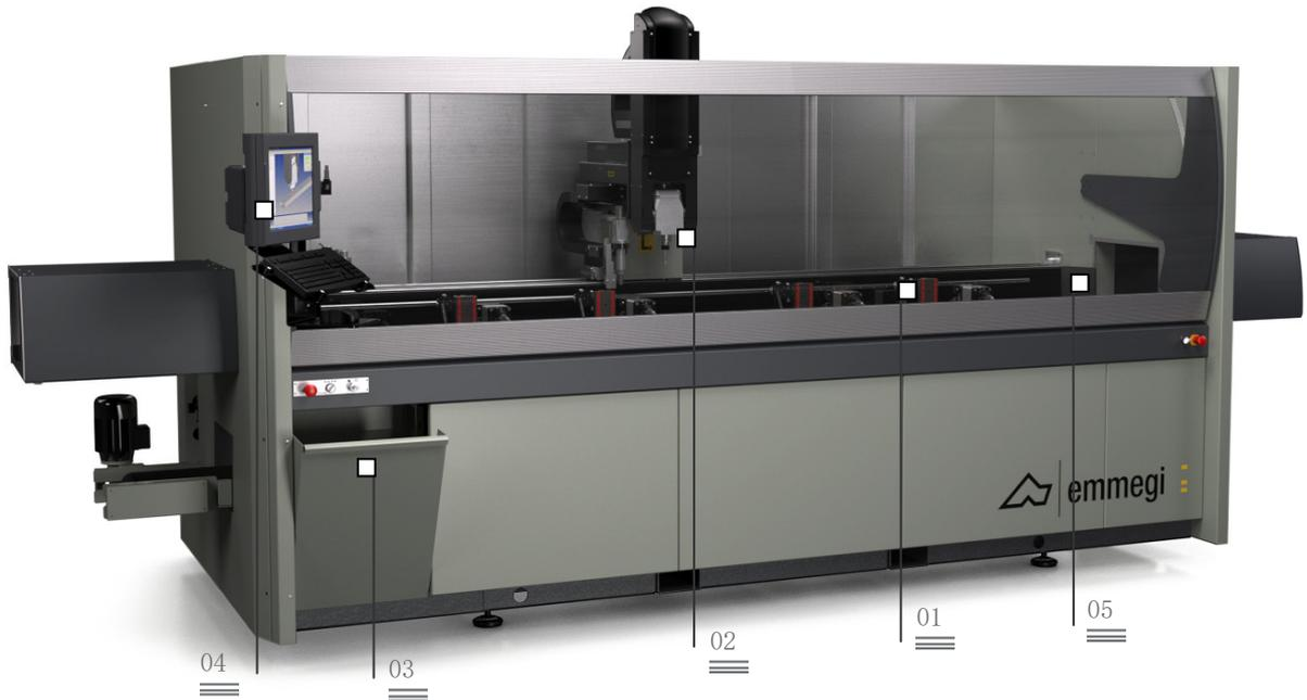
4轴CNC加工中心，由刀具自动旋转系统进行控制，可以对工件进行三面加工。它专用于铝质、聚氯乙烯、一般轻合金或钢杆和工件的加工，加工厚度可达2毫米。加工房左侧备有一个9座的手控刀具仓库和一个4座的自动刀具仓库。作为选配，加工房右侧可添加第二个4座自动工具仓库。型材通过左边的一个气动挡板来定位，通过由X轴自动定位的4个坚固的夹具来固定。还可以选择在右边安装另一个气动挡板，由此可以对有加工区两倍长度的杆条进行加工。还装配有一个活动工作台，可以方便对工件的加载/卸载，还可以大大扩大加工面。
