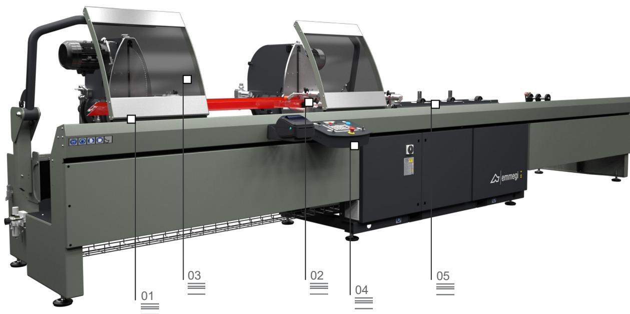
Máquina de corte com cabeça dupla eletrônica e com movimento automático da cabeça móvel através de motor Brushless comandado por controlo numérico. Inclinação pneumática das unidades de corte de 90° até 22°30' (externa) com sistema mecânico de regulação dos ângulos intermédios. Avanço óleo-pneumático do disco de corte.
