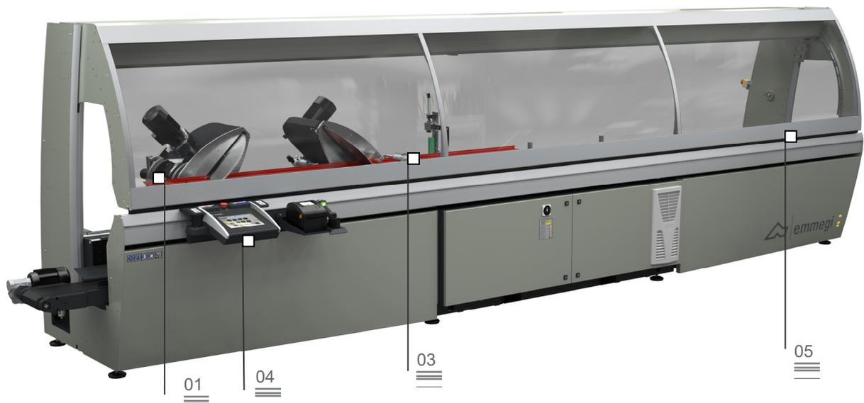
Tronçonneuse double tête à 5 axes contrôlés pour aluminium, PVC et alliages légers, avec mouvement automatique de la tête mobile et gestion électronique de tous les angles de 45° (internes) à 15° (externes) avec une précision, à l'intérieur de chaque degré, de 280 positions.
