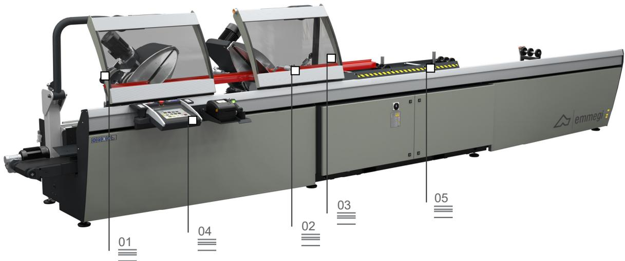
Coupeuse double tête à 3 axes contrôlés avec mouvement automatique de la tête mobile et gestion électronique de tous les angles de 45° (internes) à 15° (externes) avec une précision, à l'intérieur de chaque degré, de 280 positions.
