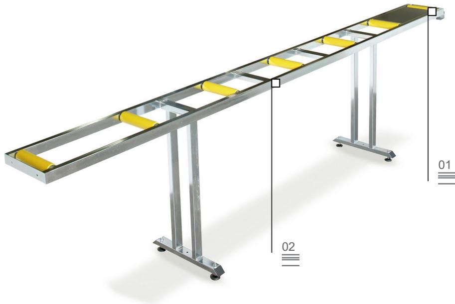
钢管制作的机构，带有可调节的小脚；安装直径 240 mm 辊子的辊道，总长度为 3500 mm；安装直径 440 mm 辊子的辊道，总长度为 4000 mm。
