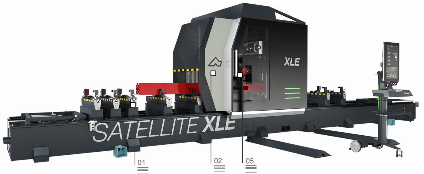
Centro de corte y mecanizado de 5 ejes CNC con portal móvil, sirve para fresar, taladrar, roscar y cortar barras de grandes dimensiones de aluminio, PVC, aleaciones ligeras y acero. La parte móvil de la máquina está compuesta por un portal motorizado con cremallera de precisión. El electromandril de potencia elevada (11 kW en S1) con cono portaherramientas HSK-63F permite efectuar elaboraciones, incluso difíciles, con precisión y rapidez.
