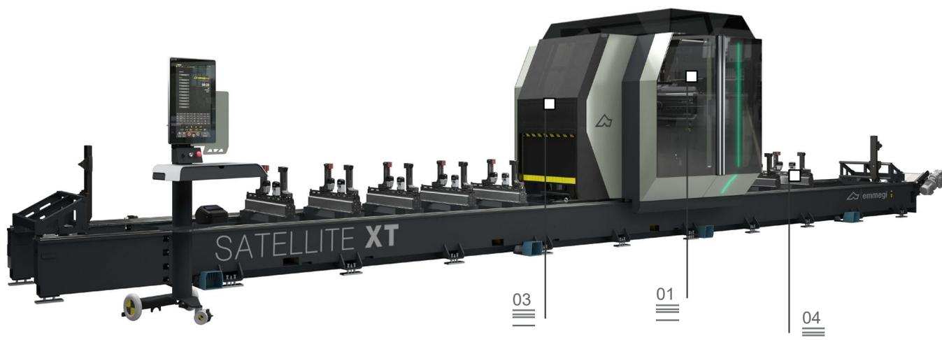
Centro de trabalho de 5 eixos CNC de portal móvel, realizado para executar laborações de fresagem, furação, roscagem e corte em barras de grandes dimensões em alumínio, PVC, ligas leves e aço. A parte móvel da máquina é constituída por um portal dotado de motorização com cremalheira de precisão. O eletromandril de potência elevada (15 kW em S1) com engate de ferramentas HSK-63F permite realizar trabalhos, inclusivamente gravosos, com ótimos resultados de rapidez e precisão.
