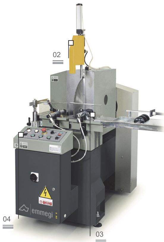
Tronçonneuse simple tête avec lame frontale, côté de chargement sur la gauche et double pivotement latéral à commande pneumatique en positions fixes: 45° gauche et 90°, 45° et 22°30' droite. Une butée mécanique spécifique assure également la coupe à des angles intermédiaires
