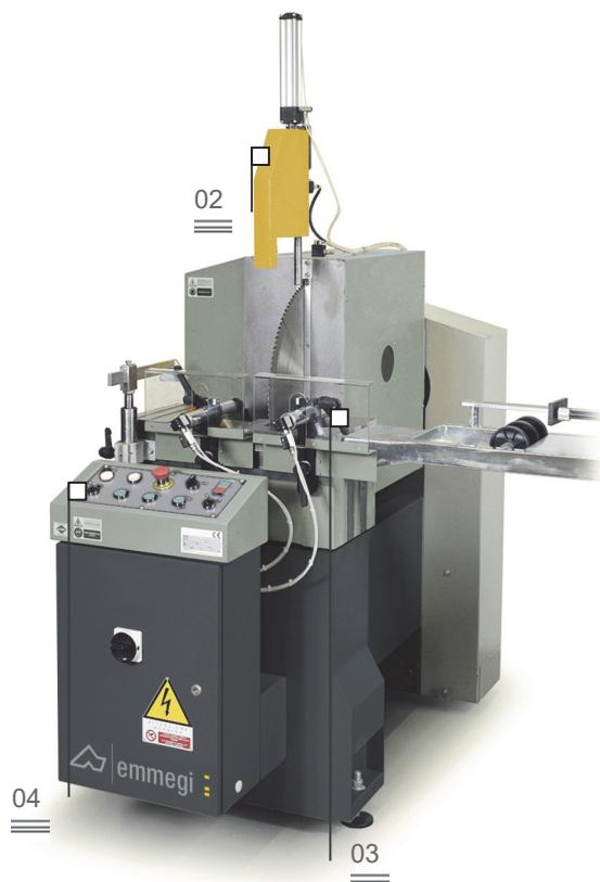
Máquina de corte monocabeça com lâmina de corte frontal, lado de carga à esquerda e duplo basculamento lateral com comando pneumático em posições fixas: 45° à esquerda e 90°, 45° e 22°30' à direita. Um específico encosto mecânico permite também o corte em ângulos intermediários.
