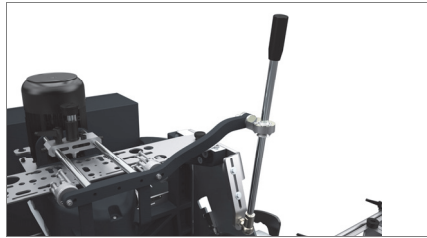
Umlenkhebel für das Verfahren des Kopfs
