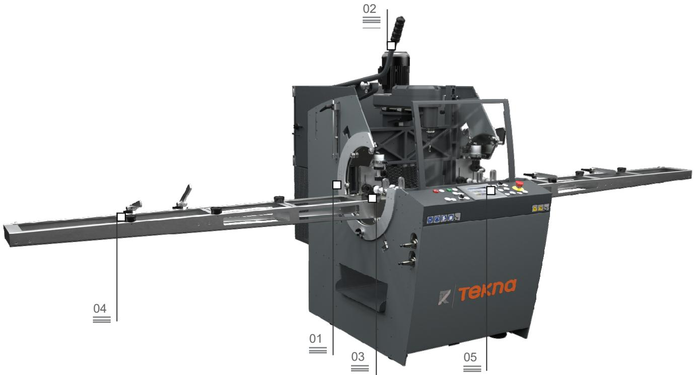
Fraiseuse à copier à 2 axes contrôlés, idéal pour l'usinage de profilés en aluminium, PVC et acier jusqu'à 2 mm d'épaisseur permettant aussi d'usiner l'acier inoxydable (optionnel) jusqu'à 2 mm d'épaisseur.
