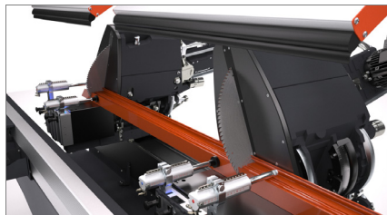
Virtuelle Neigungsachse der Sägeeinheiten 01
